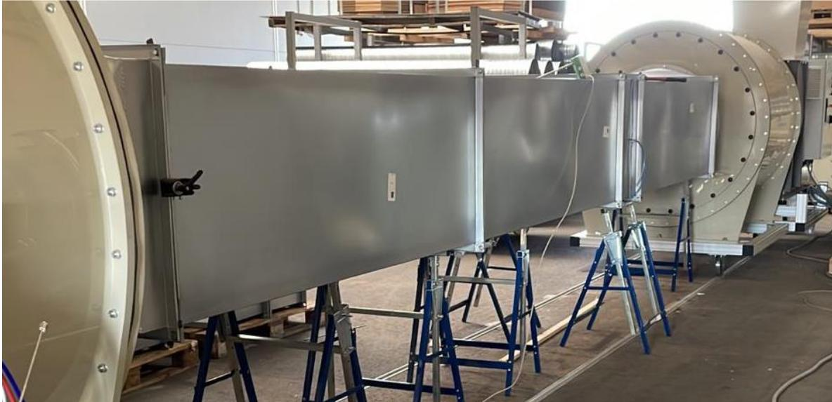
**Abb. 4: Bei der Kalibration im Luftmeister-Labor muss für jeden Zähler die passende Ein- und Auslaufstrecke adaptiert werden – anschließend wird auf einen hochgenauen Durchfluss justiert. Quelle: Luftmeister GmbH.**
